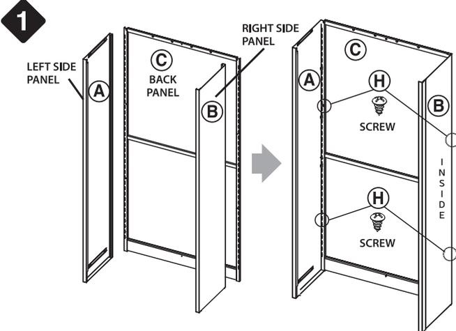
**Pic 1:** Join (C) BACK PANEL to (A) LEFT SIDE PANEL & (B) RIGHT SIDE PANEL using (H) SCREWS
